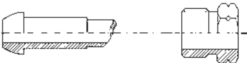
Bild 7: Pol-Anschluss von Druckregelgeräten für Druckbehälter
